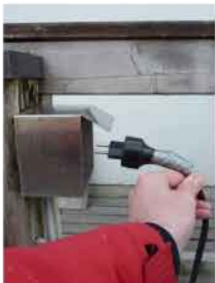
Enlever la prise de connexion Le cordon reste sur le bateau !
